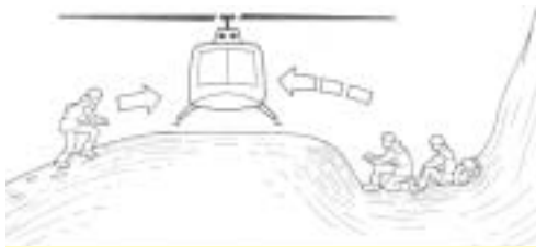
C15-15 Avvicinamento su pendio
