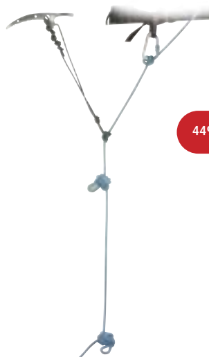
C12-06 Ancoraggio provvisorio 1
