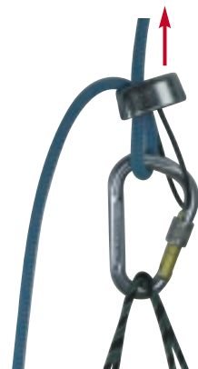
C09-17 Posizione del tuber con rami di corda, in entrata e uscita dal freno, posti a 180°
